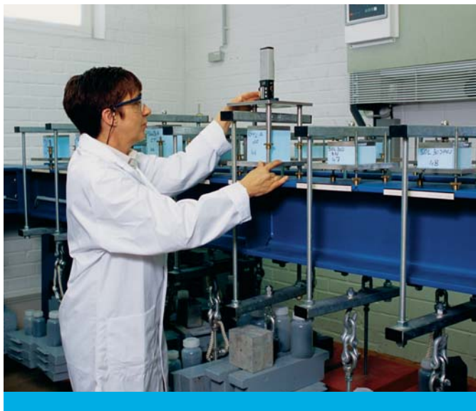
Fig. 10: Prove di valutazione dello scorrimento viscoso nel laboratorio Ravago Building Solutions dedicato.
