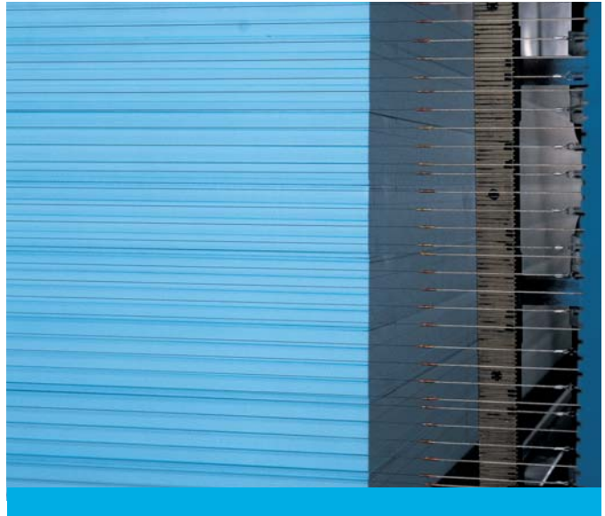
Fig. 13: Macchina per il taglio a filo caldo oscillante
