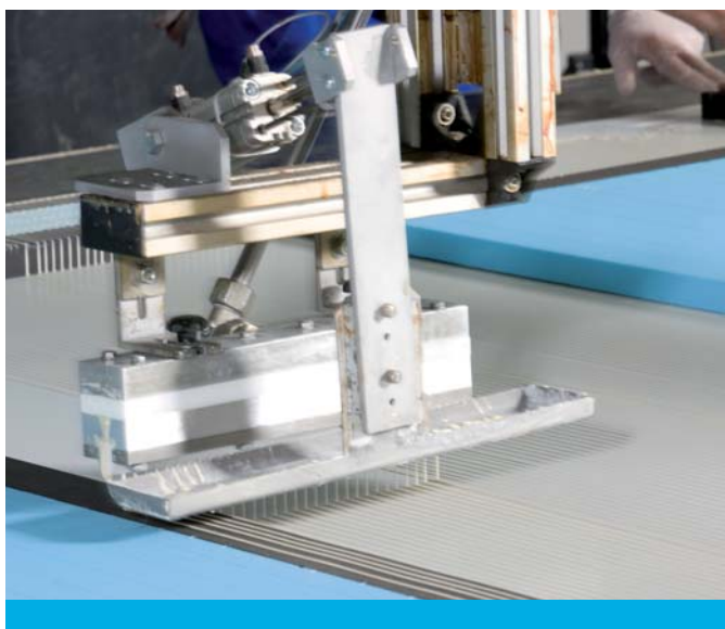
Fig. 15: Applicazione di adesivo poliuretano bicomponente
