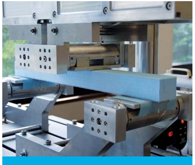
Fig. 12: Prova dinamica eseguita sui pannelli sandwich con anima in STYROFOAM™
