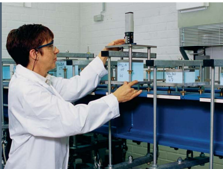
Fig. 16: Controllo della deformazione plastica secondo la norma EN 1606
