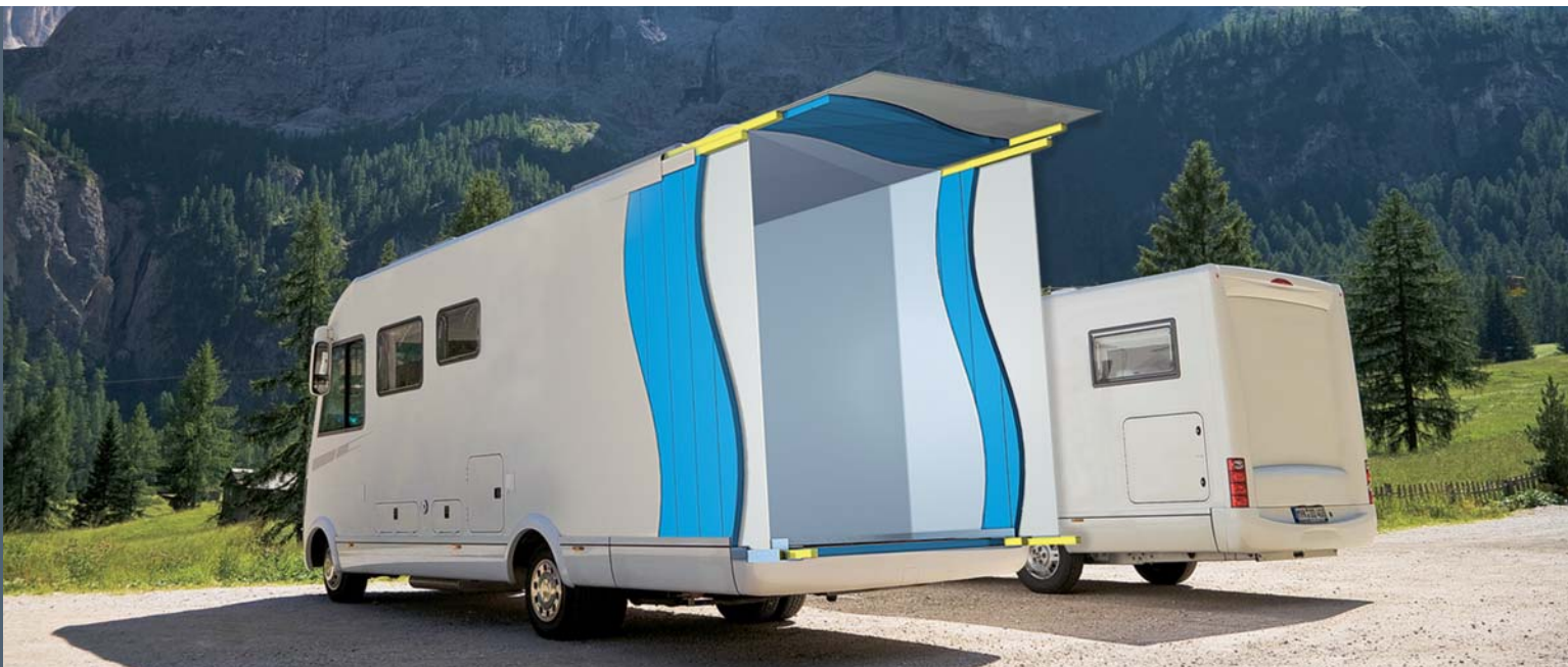
Fig. 1: Sezione di un camper (schema semplificato che illustra l'impiego di STYROFOAM™)
