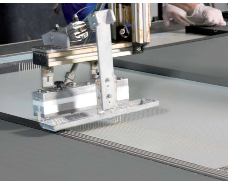
Fig. 9: Incollatura di pannelli STYROFOAM™ scanalati
